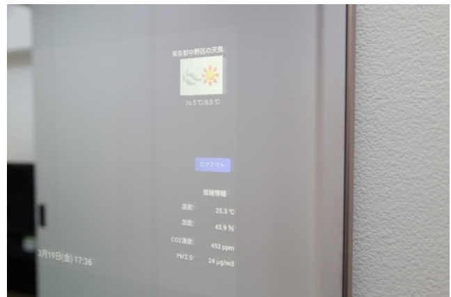
各種情報を表示できるスマートミラー (健康情報・空気環境センサー情報・周辺天気など)
